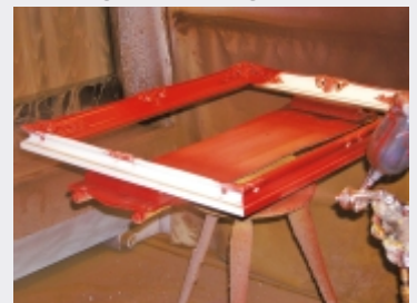
Auftrag der Untergrundfarbe
